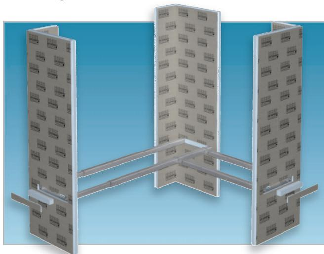
Le montage de l'ossature en acier inoxydable pour le CONCEPT-BA-FLOAT dans la construction murale CONCEPT-WA... (voir page 142) s'effectue par l'intermédiaire d'encoches réalisées en usine dans les éléments de coin. La hauteur de la banquette est définie par défaut à 45 cm (autres hauteurs possibles sur demande).
