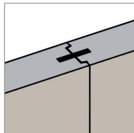
Jonction des panneaux par languette et fraisage en V
